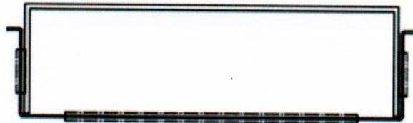
COMAX P Kastenbreite 60-80-110-140-160-190-220-240 Kastenhöhe 30mm
