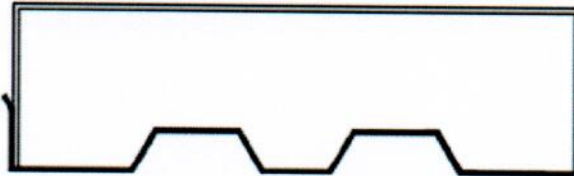
COMAX Q Kastenbreite 60-80-110-140-160-190-220-240 Abdeckung Zellulose / PVC ; Endkappe Styropor Kastenhöhe 30mm
