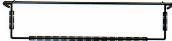
COMAX P Kastenbreite 60-80-110-140-160-190-220-240 Kastenhöhe 30mm
