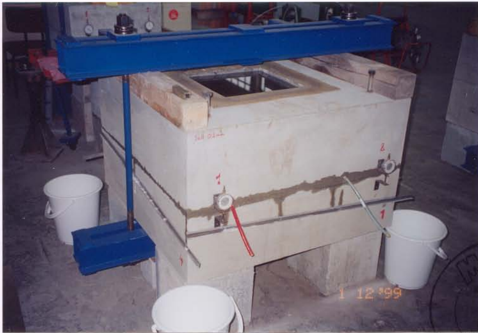
Bild 3: Undichtigkeiten der noch nicht verpressten Arbeitsfuge
