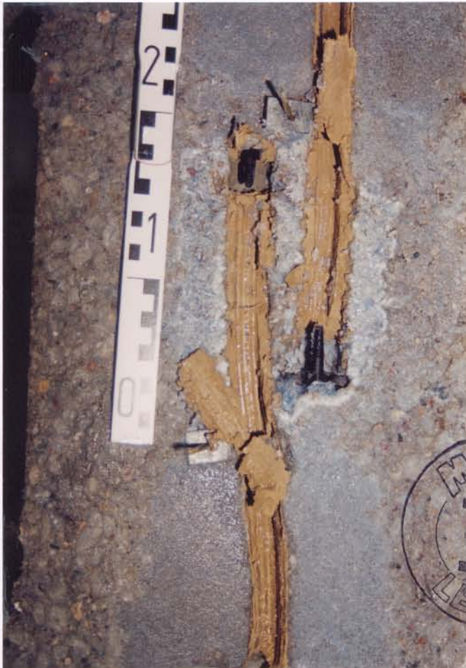
Bild 4: Mit Acrylatgel gefülltes Kiesnest nach Beendigung der Prüfung
