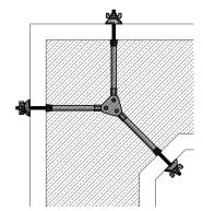
Der B15 Eckspanner wird verwendet um eine Spannstelle über Eck anordnen zu können, z.B. bei Widerlagern.
