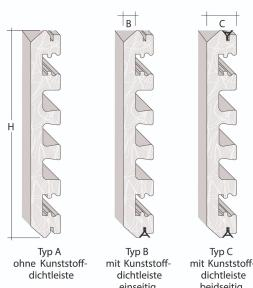
Das Faserbeton-Profil zum Abschalen von Balkonaufkantungen, Wand- u. Deckenendabschalungen sowie Tür- u. Fensteraussparrungen. Die Oberfläche ist glatt und die Kanten sind beidseitig gefast. Die Profilenden sind werkseitig gesägt und kann mit einem Diamantsägeblatt auf eine beliebige Länge zugeschnitten werden. Der Profil-Typ A wird ohne Dichtleiste geliefert.
