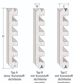
Das Faserbeton-Profil zum Abschalen von Balkonaufkantungen, Wand- u. Deckenendabschalungen sowie Tür- u. Fensteraussparrungen. Die Oberfläche ist glatt und die Kanten sind beidseitig gefast. Die Profilenden sind werkseitig gesägt und kann mit einem Diamantsägeblatt auf eine beliebige Länge zugeschnitten werden. Der Profil-Typ A wird ohne Dichtleiste geliefert.
