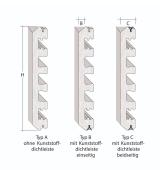
Das Faserbeton-Profil zum Abschalen von Balkonaufkantungen, Wand- u. Deckenendabschalungen sowie Tür- u. Fensteraussparrungen. Die Oberfläche ist glatt und die Kanten sind beidseitig gefast. Die Profilenden sind werkseitig gesägt und kann mit einem Diamantsägeblatt auf eine beliebige Länge zugeschnitten werden. Der Profil-Typ A wird ohne Dichtleiste geliefert.
