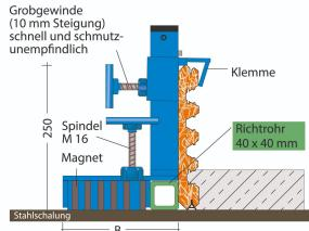
Die Magnetklemme MK 3 wird zum Befestigen von Abschalprofilen auf Stahlschalungen verwendet. Sie kommen zum Einsatz beim Abschalen von Balkonaufkantungen, Wand- u. Deckenendabschalungen sowie Tür- u. Fensteraussparungen. Das Standrohr ist fest verschweißt. In der Magnetklemme können Profile bis zu einer Breite von 250 mm eingespannt werden. Auf Anfrage können die Standrohre auch in einer höheren Ausführung geliefert werden.
