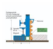
Die Magnetklemme MK 3 wird zum Befestigen von Abschalprofilen auf Stahlschalungen verwendet. Sie kommen zum Einsatz beim Abschalen von Balkonaufkantungen, Wand- u. Deckenendabschalungen sowie Tür- u. Fensteraussparrungen. Das Standrohr ist fest verschweißt. In der Magnetklemme können Profile bis zu einer Breite von 250 mm eingespannt werden. Auf Anfrage können die Standrohre auch in einer höheren Ausführung geliefert werden.
