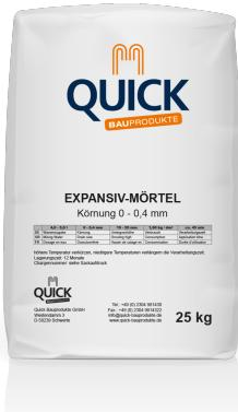
Der Expansiv-Mörtel EM 0-0,4 E1 wird zum Verschließen von Spannstellen und zum vermorteln von Hohlwandfugen verwendet. Er hat eine sehr große Haftkraft. Der Mörtel schrumpft nicht sondern hält sein Volumen bei und reist nicht beim erhärten ab. Mit Hilfe der Mörtel-Pressen wird er in die Löcher oder Fugen eingepresst. Die Feinkörnigkeit gewährleitet das die Oberfläche glatt abgezogen werden kann. Der Mörtel kann auch mit einer geeigneten Pumpe befördert und eingebaut werden.
