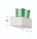
Der Supo voll kann sowohl an stehender und an liegender Bewehrung montiert werden. Die Montage ist an Bewehrungs- Ø 3-18 mm möglich. Um ein Verdrehen zu vermeiden, wird der Supo voll auf einem Bewehrungskreuzungspunkt montiert. Durch die speziell konzipierte Klammer-Form verklammert sich der Supo optimal an dem Betonstahl. Eine schnelle Montage ist gewährleistet. Die große Aufstandsfläche sorgt für eine hohe Tragfähigkeit.
