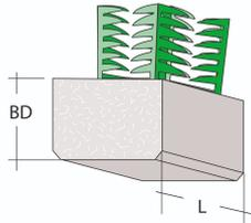
Der Supo voll kann sowohl an stehender und an liegender Bewehrung montiert werden. Die Montage ist an Bewehrungs- Ø 3-18 mm möglich. Um ein Verdrehen zu vermeiden, wird der Supo voll auf einem Bewehrungskreuzungspunkt montiert. Durch die speziell konzipierte Klammer-Form verklammert sich der Supo optimal an dem Betonstahl. Eine schnelle Montage ist gewährleistet. Die große Aufstandsfläche sorgt für eine hohe Tragfähigkeit.
