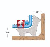
Der Supo Duo wird an Bewehrungskörben im Bügeleckbereich montiert. Er hält die Betondeckung in zwei Richtungen. Die Montage ist an Bewehrungs- Ø 3-18 mm möglich. Optional kann der Supo Duo auch mit 2 Klammern geliefert. Durch die speziell konzipierte Klammer-Form verklammert sich der Supo optimal an dem Betonstahl. Eine schnelle Montage ist gewährleistet.
