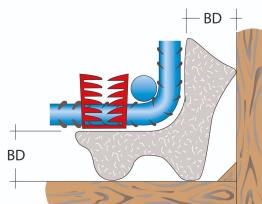
Der Supo Duo wird an Bewehrungskörben im Bügeleckbereich montiert. Er hält die Betondeckung in zwei Richtungen. Die Montage ist an Bewehrungs- Ø 3-18 mm möglich. Optional kann der Supo Duo auch mit 2 Klammern geliefert. Durch die speziell konzipierte Klammer-Form verklammert sich der Supo optimal an dem Betonstahl. Eine schnelle Montage ist gewährleistet.
