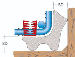
Der Supo Duo wird an Bewehrungskörben im BÜGELECKBEREICH montiert. Er hält die Betondeckung in zwei Richtungen. Die Montage ist an Bewehrungs- Ø 3-18 mm möglich. Optional kann der Supo Duo auch mit 2 Klammern geliefert. Durch die speziell konzipierte Klammer-Form verklammert sich der Supo optimal an dem Betonstahl. Eine schnelle Montage ist gewährleistet.
