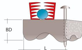
Der Montage-Supo wird zur Fixierung der Montagebewehrung verwendet. Mit dem werkseitig eingebauten Alu-Nagel wird der Montage-Supo an die Schalung genagelt. Der Bewehrungsstab ( $\varnothing$  3-18 mm) wird einfach in die Kunststoffklammer eingesteckt. Hierdurch ist ein schneller Aufbau der Bewehrung möglich. Durch die speziell konzipierte Klammer-Form verklammert sich der Supo optimal an dem Betonstahl.
