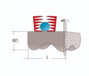
Der Montage-Supo wird zur Fixierung der Montagebewehrung verwendet. Mit dem werkseitig eingebauten Alu-Nagel wird der Montage-Supo an die Schalung genagelt. Der Bewehrungsstab (Ø 3-18 mm) wird einfach in die Kunststoffklammer eingesteckt. Hierdurch ist ein schneller Aufbau der Bewehrung möglich. Durch die speziell konzipierte Klammer-Form verklammert sich der Supo optimal an dem Betonstahl.
