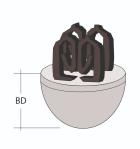
Der Gießbetonabstandhalter hat eine runde Aufstandsfläche. Die Doppelklammer verklammert sich gut an den Bewehrungsstahl. Der Abstandhalter kann sowohl an stehender und an liegender Bewehrung montiert werden. Die Montage ist an Bewehrungs- Ø 6-16 mm möglich.
