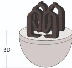
Der Gießbetonabstandhalter hat eine runde Aufstandsfläche. Die Doppelklammer verklammert sich gut an den Bewehrungsstahl. Der Abstandhalter kann sowohl an stehender und an liegender Bewehrung montiert werden. Die Montage ist an Bewehrungs- Ø 6-16 mm möglich.
