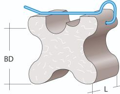
Der Kapo Knochen kann an stehender und an liegender Bewehrung montiert werden. Die Montage ist an Bewehrungs- Ø 3-10 mm möglich. Um ein Verdrehen zu vermeiden, wird der Kapo knochen auf einem Bewehrungskreuzungspunkt montiert. Die Federstahlklammer Ø 2 mm verklammert den Kapo optimal an dem Betonstahl. Eine schnelle Montage ist gewährleistet. Die Aufstandsfläche sorgt für eine hohe Tragfähigkeit und eine geringe Aufstandsfläche.
