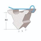
Der Kapo wird überwiegend an stehender Bewehrung montiert. Die Montage ist an Bewehrungs- Ø 3-10 mm möglich. Um ein Verdrehen zu vermeiden, wird der Kapo auf einem Bewehrungskreuzungspunkt montiert. Die Federstahlklammer Ø 2 mm verklammert den Kapo optimal an dem Betonstahl. Eine schnelle Montage ist gewährleistet. Durch die genoppte Auflagefläche erzielt man eine sehr gute Sichtbetonoberfläche. Auf Wunsch kann der Beton auch in anderen Farbtönen geliefert werden.
