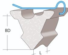
Der Kapo wird überwiegend an stehender Bewehrung montiert. Die Montage ist an Bewehrungs- Ø 3-10 mm möglich. Um ein Verdrehen zu vermeiden, wird der Kapo auf einem Bewehrungskreuzungspunkt montiert. Die Federstahlklammer Ø 2 mm verklammert den Kapo optimal an dem Betonstahl. Eine schnelle Montage ist gewährleistet. Durch die genoppte Auflagefläche erzielt man eine sehr gute Sichtbetonoberfläche. Auf Wunsch kann der Beton auch in anderen Farbtönen geliefert werden.
