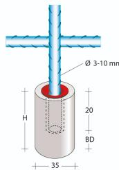
Der BWA wird am Ende der Bewehrung montiert. Die Montage ist an Bewehrungs- Ø 3-10 mm möglich. Die Kunststoffklammer sorgt für einen sicheren Halt. Die Einstekttiefe liegt bei 20 mm.
