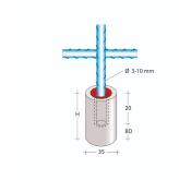
Der BWA wird am Ende der Bewehrung montiert. Die Montage ist an Bewehrungs- Ø 3-10 mm möglich. Die Kunststoffklammer sorgt für einen sicheren Halt. Die Einstecktiefe liegt bei 20 mm.
