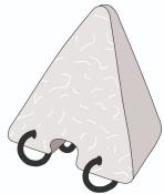
Die Roka-P Pyramide wird an stehender Bewehrung montiert. Die zwei Federstahlklammern Ø 2 mm verklammern die Pyramide optimal an dem Betonstahl. Eine schnelle Montage ist gewährleistet. Durch die punktförmige Aufstandsfläche erzielt man eine sehr gute Sichtbetonoberfläche. Die Nut -Breite und -Tiefe wird gemäß dem Bedarf hergestellt.
