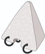
Die Roka-P Pyramide wird an stehender Bewehrung montiert. Die zwei Federstahlklammern Ø 2 mm verklammern die Pyramide optimal an dem Betonstahl. Eine schnelle Montage ist gewährleistet. Durch die punktförmige Aufstandsfläche erzielt man eine sehr gute Sichtbetonoberfläche. Die Nut-Breite und -Tiefe wird gemäß dem Bedarf hergestellt. Der Beton ist chemisch beständig.
