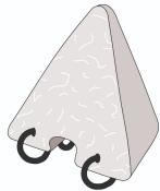
Die Roka-P Pyramide wird an stehender Bewehrung montiert. Die zwei Federstahlklammern Ø 2 mm verklammern die Pyramide optimal an dem Betonstahl. Eine schnelle Montage ist gewährleistet. Durch die punktförmige Aufstandsfläche erzielt man eine sehr gute Sichtbetonoberfläche. Die Nut-Breite und -Tiefe wird gemäß dem Bedarf hergestellt. Der Beton ist chemisch beständig.
