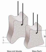
Der Bipo mit Draht kann an stehender und an liegender Bewehrung montiert werden. Der Bipo wird standardmäßig mit einer flachen Aufstandsfläche hergestellt und kann auf Wunsch auch mit einer Mulde geliefert werden. Die Bipo werden mit einem eingestecktem verzinkten Bindedraht geliefert.
