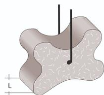
Der Bipo-Knochen mit Draht kann an stehender und an liegender Bewehrung montiert werden. Die Knochenform ermöglicht drei unterschiedliche Betondeckungshöhen. Die Bipo-Knochen werden mit einem eingestecktem verzinktem Bindedraht geliefert.
