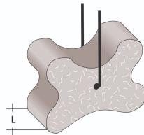
Der Bipo-Knochen mit Draht kann an stehender und an liegender Bewehrung montiert werden. Die Knochenform ermöglicht drei unterschiedliche Betondeckungshöhen. Die Bipo-Knochen werden mit einem eingestecktem schwarzen Bindedraht geliefert.
