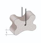
Der Bipo-Knochen mit Draht kann an stehender und an liegender Bewehrung montiert werden. Die Knochenform ermöglicht drei unterschiedliche Betondeckungshöhen. Die Bipo-Knochen werden mit einem eingestecktem schwarzen Bindedraht geliefert.
