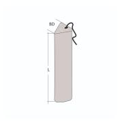
Der Dreika K1 wird bei stehender Bewehrung eingesetzt. Die Länge des Dreika ist für einen Betonstahl-Abstand bis max. 27 cm ausgelegt. Werkseitig ist eine Stahlklammer Ø2 mm montiert. Der Dreika kann an Betonstahl-Ø 6-14 mm montiert werden. Die Klammer gewährleistet eine sehr schnelle Montage. Durch die Befestigung und längliche Form ist der Dreika kippsicher und stabil.
