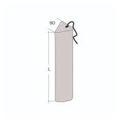
Der Dreika K1 wird bei stehender Bewehrung eingesetzt. Die Länge des Dreika ist für einen Betonstahl-Abstand bis max. 27 cm ausgelegt. Werkseitig ist eine Stahlklammer Ø2 mm montiert. Der Dreika kann an Betonstahl-Ø 6-14 mm montiert werden. Die Klammer gewährleistet eine sehr schnelle Montage. Durch die Befestigung und längliche Form ist der Dreika kippsicher und stabil.
