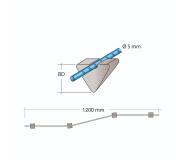
Der FSA Pyramide ist ein Flächenabstandhalter der bei liegender und stehender Bewehrung eingesetzt werden kann. Die pyramidenförmigen Faserbetonabstandhalter haben eine punktförmige Aufstandsfläche und eignen sich perfekt für den Einsatz von Sichtbetonoberflächen. Die FB-Pyramiden sind feste und stabil an einem Betonstahl Ø6 mm verklebt.
