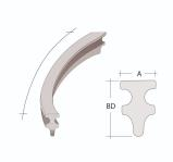
Der Bumerang ist ein Flächenabstandhalter und wird bei liegender Bewehrung eingesetzt. Die Aufstandsfläche ist ungenoppt und sollte daher in untergeordneten Bauteilen ohne hohe Sichtbetonanforderungen eingesetzt werden. Die 25 cm Länge eignet sich für den Einsatz bei Q-Betonstahlmatten mit einer Maschenweite 15x15 cm. Durch die Biegung ist der Bumerang lagesicher und er kippt nicht um.
