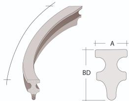
Der Bumerang ist ein Flächenabstandhalter und wird bei liegender Bewehrung eingesetzt. Die Aufstandsfläche ist ungenoppt und sollte daher in untergeordneten Bauteilen ohne hohe Sichtbetonanforderungen eingesetzt werden. Die 25 cm Länge eignet sich für den Einsatz bei Q-Betonstahlmatten mit einer Maschenweite 15x15 cm. Durch die Biegung ist der Bumerang lagesicher und er kippt nicht um.
