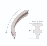
Der Bumerang ist ein Flächenabstandhalter und wird bei liegender Bewehrung eingesetzt. Die Aufstandsfläche ist ungenoppt und sollte daher in untergeordneten Bauteilen ohne hohe Sichtbetonanforderungen eingesetzt werden. Die 33 cm Länge eignet sich für den Einsatz bei R-Betonstahlmatten mit einer Maschenweite 15x25 cm. Durch die Biegung ist der Bumerang lagesicher und er kippt nicht um.
