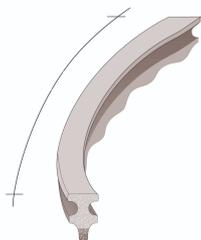
Der Bumerang ist ein Flächenabstandhalter und wird bei liegender Bewehrung eingesetzt. Die Aufstandsfläche ist genoppt und eignet sich sehr gut für Bauteile mit Sichtbetonanforderungen. Die 33 cm Länge kommt zum Einsatz bei Q-Betonstahlmatten mit einer Maschenweite 25x15 cm. Durch die Biegung ist der Bumerang lagesicher und er kippt nicht um.
