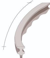
Der Bumerang ist ein Flächenabstandhalter und wird bei liegender Bewehrung eingesetzt. Die Aufstandsfläche ist genoppt und eignet sich sehr gut für Bauteile mit Sichtbetonanforderungen. Die 33 cm Länge kommt zum Einsatz bei Q-Betonstahlmatten mit einer Maschenweite 25x15 cm. Durch die Biegung ist der Bumerang lagesicher und er kippt nicht um.
