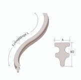
Der Aal 20/50 ist ein Flächenabstandhalter und wird im Bereich von Bodenplatten bei liegender Bewehrung eingesetzt. Die Aufstandsfläche ist ungenoppt und stabil. Durch die zwei Biegungen ist er kipp- und lagesicher. Eine schnelle Montage ist garantiert.
