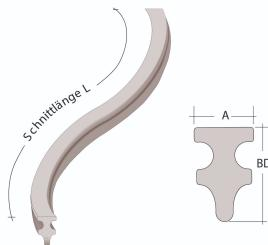
Der Aal 20/80 ist ein Flächenabstandhalter und wird im Bereich von Bodenplatten bei liegender Bewehrung eingesetzt. Die Aufstandsfläche ist ungenoppt und stabil. Durch die zwei Biegungen ist er kipp- und lagesicher. Eine schnelle Montage ist garantiert.
