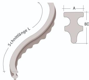
Der Aal 20/50 N ist ein Flächenabstandhalter und wird z.B. im Bereich von Decken und Unterzügen bei liegender Bewehrung eingesetzt. Die Aufstandsfläche ist genoppt. Der Beton unterläuft die Noppung. ideal für Sichtbetonflächen. Durch die zwei Biegungen ist er kipp- und lagesicher. Eine schnelle Montage ist garantiert.
