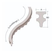
Der Aal 20/50 N ist ein Flächenabstandhalter und wird z.B. im Bereich von Decken und Unterzügen bei liegender Bewehrung eingesetzt. Die Aufstandsfläche ist genoppt. Der Beton unterläuft die Noppung. ideal für Sichtbetonflächen. Durch die zwei Biegungen ist er kipp- und lagesicher. Eine schnelle Montage ist garantiert.
