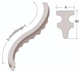
Der Aal 20/80 N ist ein Flächenabstandhalter und wird z.B. im Bereich von Decken und Unterzügen bei liegender Bewehrung eingesetzt. Die Aufstandsfläche ist genoppt. Der Beton unterläuft die Noppung. Ideal für Sichtbetonflächen. Durch die zwei Biegungen ist er kipp- und lagesicher. Eine schnelle Montage ist garantiert.
