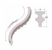
Der Aal 20/80 N ist ein Flächenabstandhalter und wird z.B. im Bereich von Decken und Unterzügen bei liegender Bewehrung eingesetzt. Die Aufstandsfläche ist genoppt. Der Beton unterläuft die Noppung. Ideal für Sichtbetonflächen. Durch die zwei Biegungen ist er kipp- und lagesicher. Eine schnelle Montage ist garantiert.
