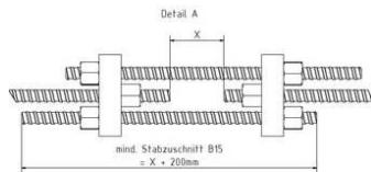
Das Spannschloss B15 wird zum Verbinden und Vorspannen von BETOMAX® Ankerstangen verwendet.
