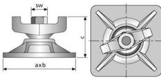
Kugelgelenkplatten, verzinkt. Zum Einsatz bei geneigten Schalungen. Auch kompatibel mit Uni 15.
