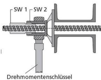
Aus Automatenstahl. Verzinkt. Feingewinde zum Vorspannen. Auch kompatibel mit Uni-Stäben.
