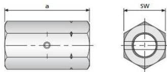
Aus Automatenstahl mit Anschlagstift zum Koppeln von Ankerstäben.
