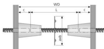
Die quadratische Wassersperrplatte 120 x 120 mm verhindert die Wasserumläufigkeit. Mit Nocken zur besseren Betonhaftung.
