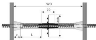
Kompatibel mit Uni 15. Die Wassersperre B 15 hat beidseitig Ansatzstutzen, auf die die Rohrzuschnitte Dist K-26 rauh dichtschließend aufgesteckt werden können. So ist gewährleistet, dass Betonschlämme nicht einfließen und den Ankerstab "einbetonieren" kann. Mit Nocken zur besseren Betonhaftung.
