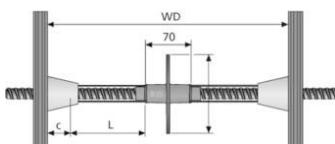
Kompatibel mit Uni 15. Die Wassersperre B 15 hat beidseitig Ansatzstutzen, auf die die Rohrzuschnitte Dist K- 26 rauh dichtschließend aufgesteckt werden können. So ist gewährleistet, dass Betonschlämme nicht einfließen und den Ankerstab "einbetonieren" kann.
