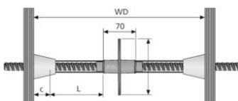
Kompatibel mit Uni 15. Die Wassersperre B 15 hat beidseitig Ansatzstutzen, auf die die Rohrzuschnitte Dist K- 26 rauh dichtschließend aufgesteckt werden können. So ist gewährleistet, dass Betonschlämme nicht einfließen und den Ankerstab "einbetonieren" kann. Reduzierkupplung für Dist K-22 und Dist FB-22. Bei Verwendung der Reduzierkupplung verändert sich das Maß 70 mm auf 125 mm.
