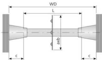
Auf Dist St-22. Verhindert die Wasserumläufigkeit. Mit dem Verschlussstopfen FLUPP St wird das Stahlrohr wasserdicht verschlossen. Kegel EX mit 35 mm oder 50 mm Betondeckung. Das Konenloch muss nach dem Entfernen des Kegels zugemörtelt bzw. mit Betonstopfen verklebt werden.
