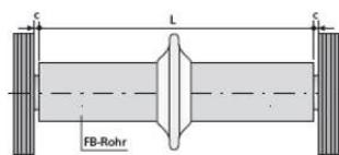
Quellaktive SD-Wassersperre verhindert zuverlässig Wasserumläufigkeit.
