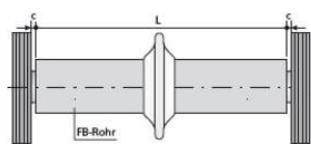
Quellaktive SD-Wassersperre verhindert zuverlässig Wasserumläufigkeit.
