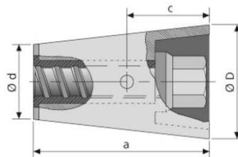
Metall-Kunststoff-Konus für den mehrfachen Einsatz in Beton. Kompatibel mit Uni-Stäben.
