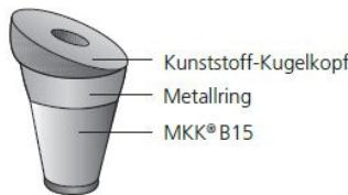
Der MKK® Vario besteht aus einem galvanisch verzinkten Metallring und einem Kunststoff-Kugelkopf. Der MKK® Vario B 15 ist mit einem Winkel ausgleich von 20° stufenlos einsetzbar.
