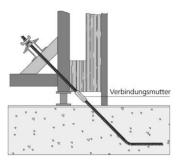
L = Überstand für Befestigung mit Verbindungsmutter
