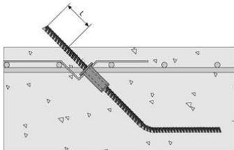
Bestehend aus Blechstreifen und Kunststoffaufnahme für Verankerungshilfen für einhäuptige Wandschalungen. Zum Einbau von Ankerstäben, Verankerungsschlaufen, Wellenanker, Schlaufenhaken etc. unter 45° Neigung.
