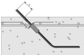
Bestehend aus Blechstreifen und Kunststoffaufnahme für Verankerungshilfen für einhäuptige Wandschalungen. Zum Einbau von Ankerstäben, Verankerungsschlaufen, Wellenanker, Schlaufenhaken etc. unter 45° Neigung.
